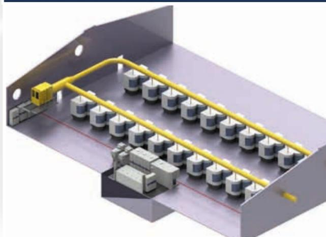
Zentrales Abluftabsaugsystem aus dezentralen Abluftfiltern der Bearbeitungsmaschinen oder mit zentralem Abluftfilter.
