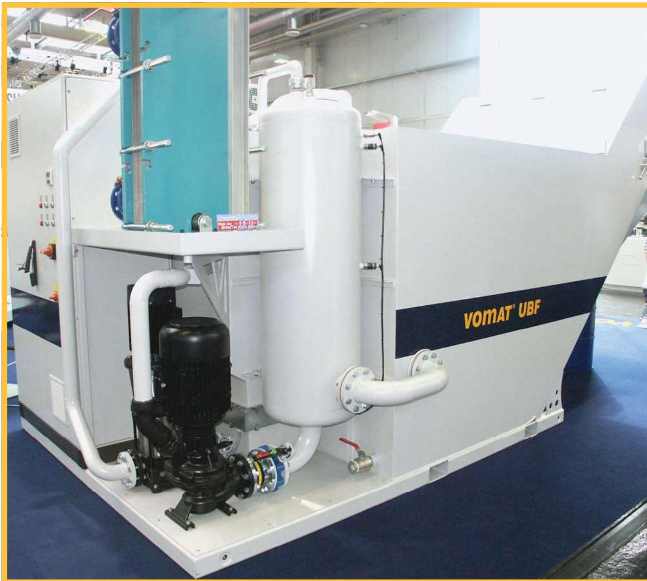
НОВЫЙ ВАКУУМНЫЙ ЛЕНТОЧНЫЙ ФИЛЬТР VOMAT UBF ПО СРАВНЕНИЮ С СУЩЕСТВУЮЩИМИ НА СЕГОДНЯШНИЙ ДЕНЬ СХОЖИМИ СИСТЕМАМИ ФИЛЬТРАЦИИ ЗАНИМАЕТ НА 70% МЕНЬШЕ МЕСТА ПРИ 100% ПРОИЗВОДИТЕЛЬНОСТИ
