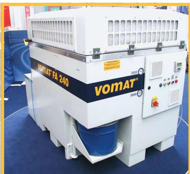
СИСТЕМЫ СВЕРХТОНКОЙ ФИЛЬТРАЦИИ VOMAT доступны в различных размерах: например, FA 240 с производительностью 240 л/мин и компактными размерами д 1600 × ш 1000 × в 1200 мм
